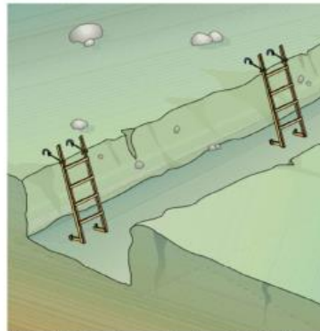
Figura 2 - Instalação de escada em escavação de via com mais de 1,25 m de altura.
