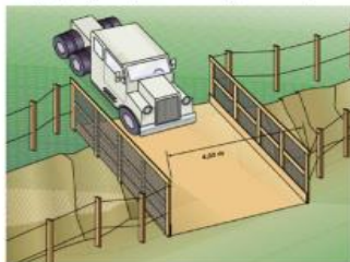
Figura 6 - Passarela para o tráfego de veículos sobre escavação.
