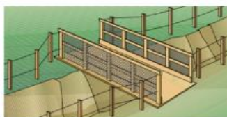
Figura 5 - Passarela em escavação para circulação de pessoas.
